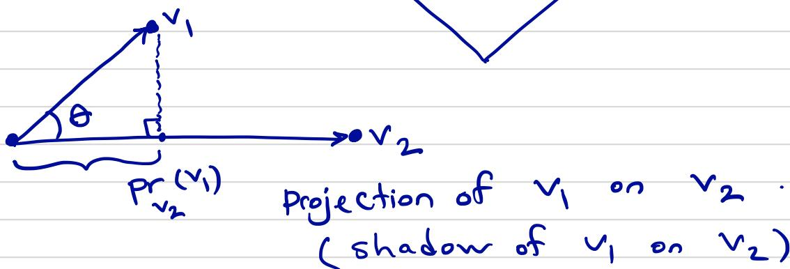
Length of proj. of  $v_1$  on  $v_2$  =  $|v_1| \cos(\theta)$ .
